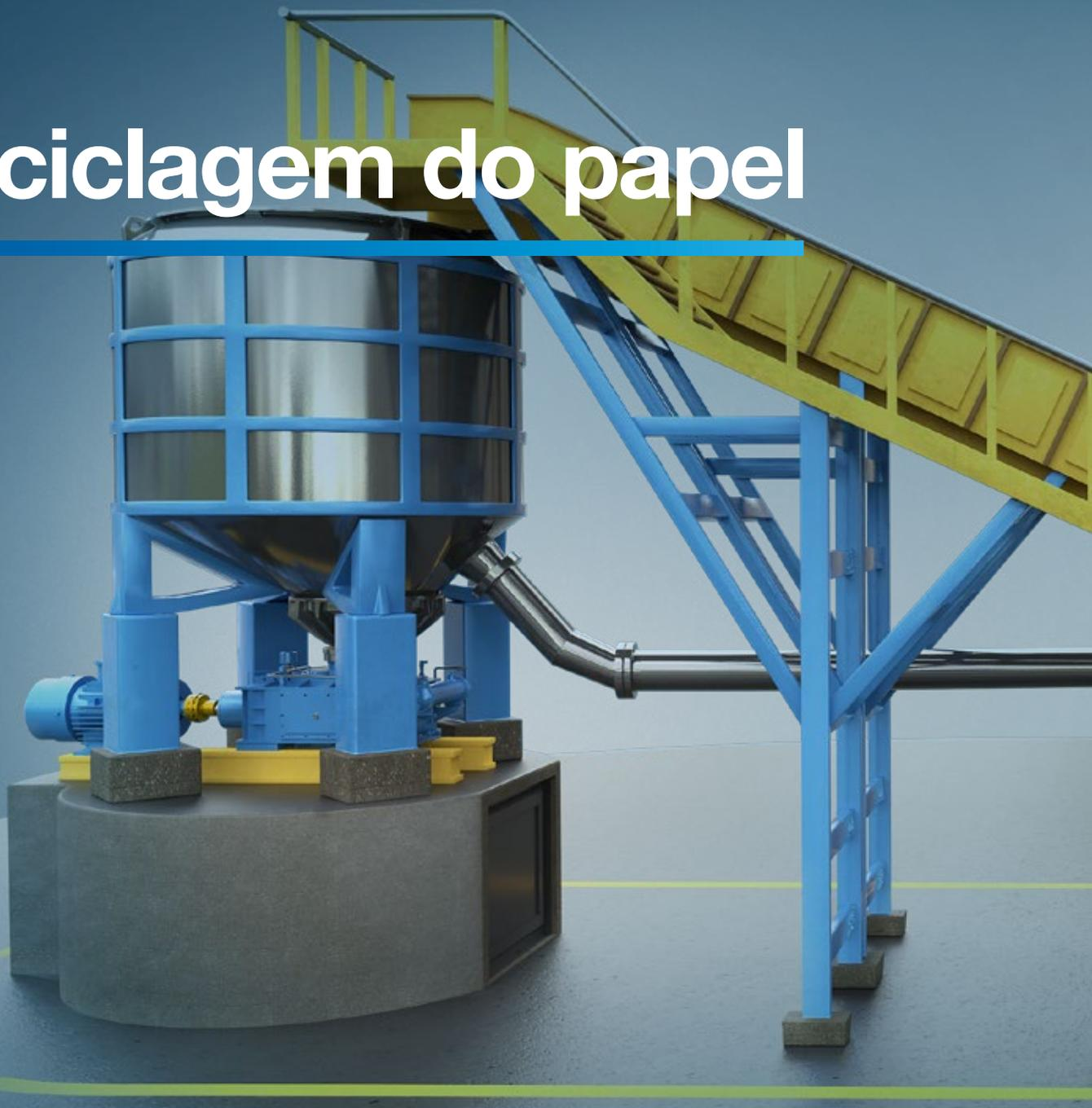
No processo de reciclagem do papel, os hidrapulpers (ou desagregadores) têm a principal função de desagregar e separar as fibras de papel dos materiais contaminantes, fazendo a agitação e mistura desse material com água. As fibras de papel, juntamente com a água, passam por uma peneira no fundo do hidrapulper que retém os contaminantes, deixando que a polpa siga o processo normal de fabricação de papel.
