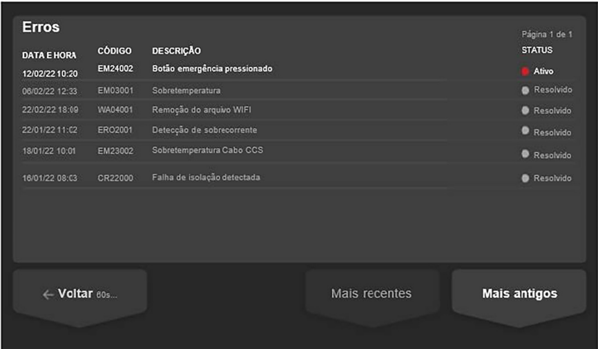
Figura 7.19: Tela com detalhes dos erros
