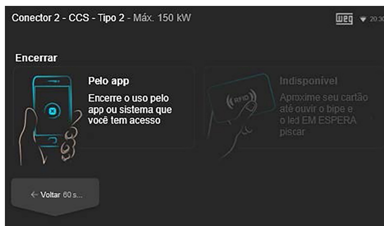
Figura 7.13: Tela de finalização da recarga via aplicativo
