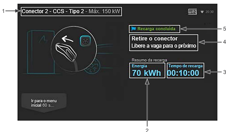
Figura 7.16: Tela com detalhes de uma recarga concluída
