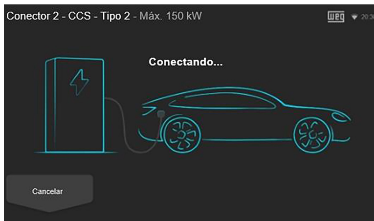
Figura 7.11: Tela indicando que o veículo elétrico foi conectado e está em processo de reconhecimento
