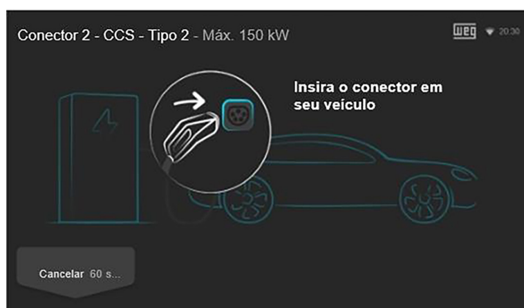
Figura 7.2: Tela de instrução para "Inserir o conector em seu veículo"
