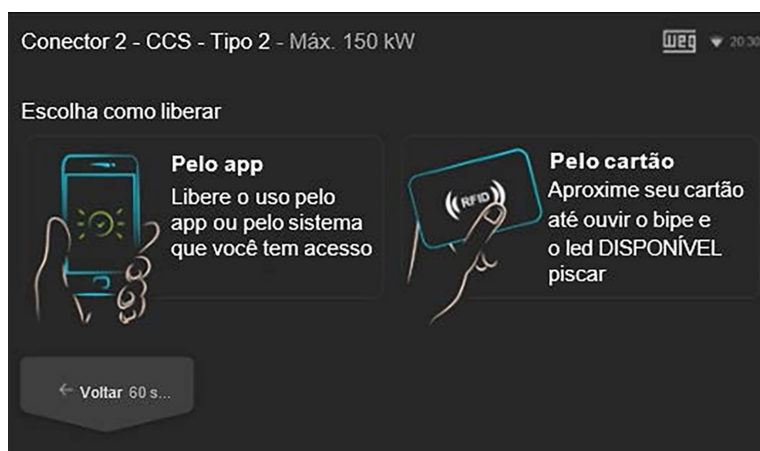
Figura 7.5: Tela para seleção do método de liberação (exemplo 150 kW)
