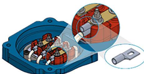
Figura 6.15: Representação do bloco de terminais "Ex eb" com orifícios oblongos na sapata de terminal
