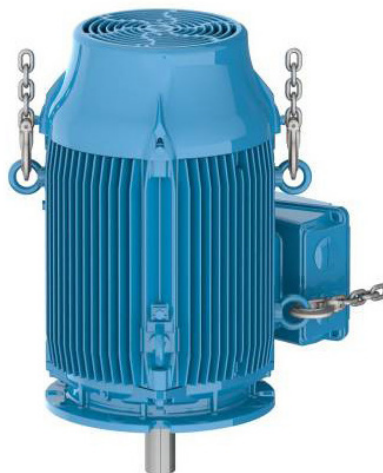
Figura 4.12: Resultado final: motor posicionado de forma vertical
