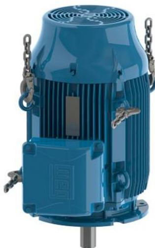
Figura 4.18: Instalação do segundo par de olhais
