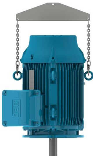
Figura 4.8: Izamiento de motores verticales
