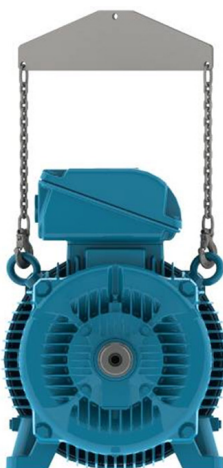
Figura 4.7: Uso de barra separadora en el izamiento
