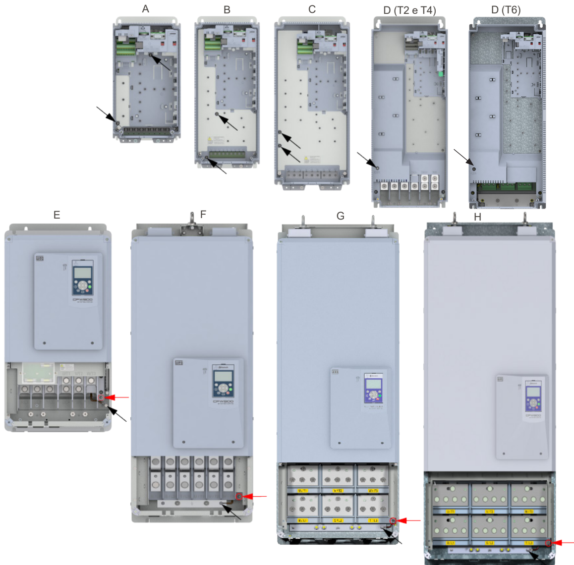
Figura 3.24: Parafusos de aterramento dos capacitores de filtro e varistores
