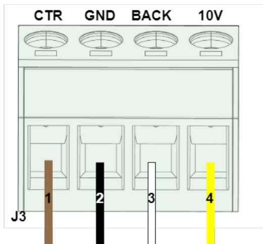
Figura 12 - Sequência de ligação do controlador
