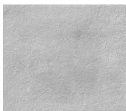
CSP 1 – Ataque ácido 685,8 \mu\text{m}^1
