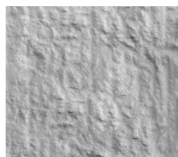
CSP 6 – Escarificação média 3.175 \mu\text{m}^1
