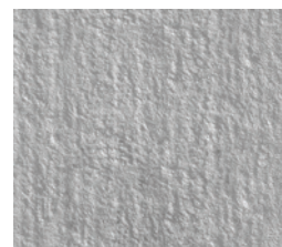
CSP 4 – Escarificação leve 1.270 \mu\text{m}^1
