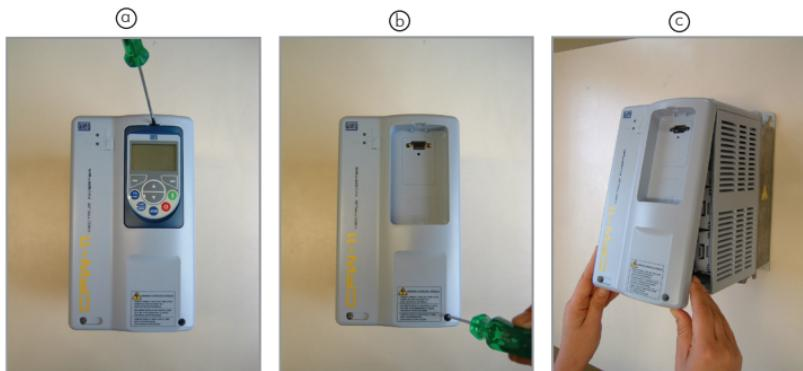
Figura 2: Remoção da tampa frontal
