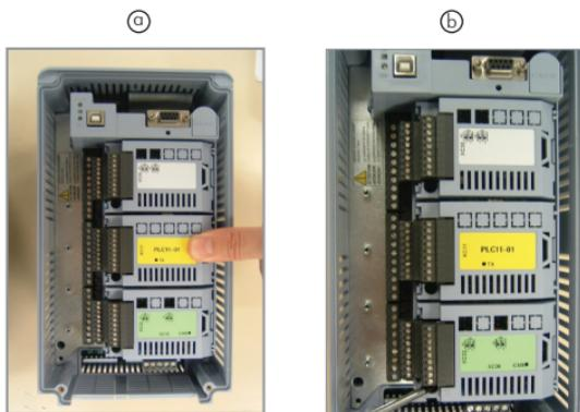
Figura 3: Instalação do acessório nos slots
