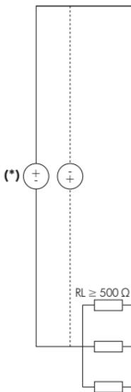
(\*) Se puede utilizar la fuente de 24 Vcc interna conectando XC30:9 en XC31:5 y XC31:4 en la carga.
