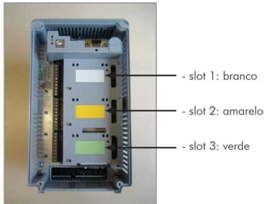
**Figura 1:** Identificação de slots para acessórios
