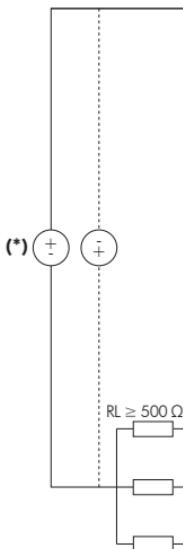
(\*) Pode-se utilizar a fonte de 24 Vcc interna ligando XC31:9 em XC31:5 e XC31:4 na carga.
