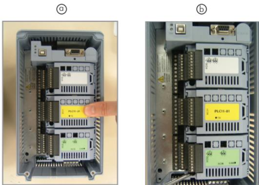
Figura 3: Instalación del accesorio en el "slot"
