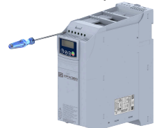
(d) Tighten the screws of the filter set (Torque: 0.51 N/m) (d) Apriete los tornillos del conjunto filtro (Torque: 0,51 N/m) (d) Aperte os parafusos do conjunto filtro (Torque: 0,51 N/m)
