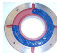
Figura 7.3: Anillo de fijación externo del cojinete
