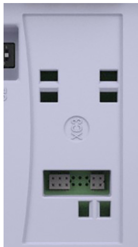
Abbildung 5.7: Anschluss für Bluetooth oder Ethernet Zubehör am XC3
