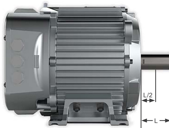
Abbildung 5.1: Radialkraft auf die Motorwelle
