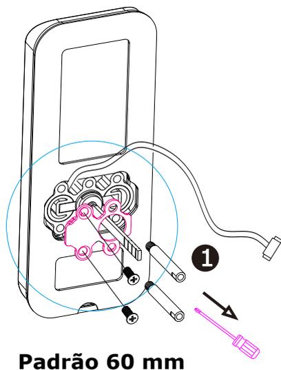
Passo 1: retire os parafusos da cobertura do cilindro.
