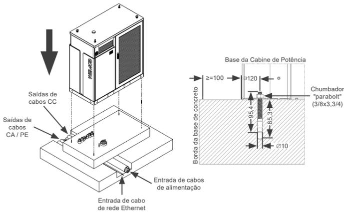
Figura 4.7: Detalhes dos pontos de fixação - mm
