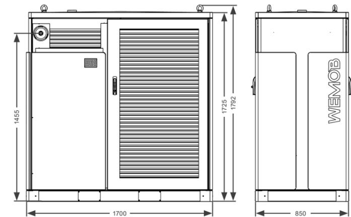
Figura 6.1: Dimensões da Cabine de Potência - mm
