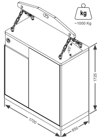
Figura 4.1: Geometria, massa e içamento recomendável para a Cabine de Potência – mm
