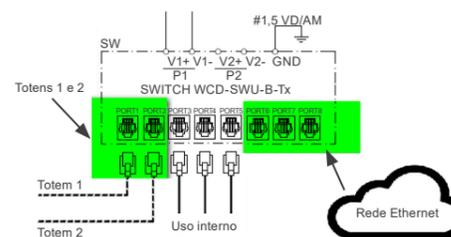
Figura 5.3: Esquema de ligação cabos Ethernet para Totems e rede externa
