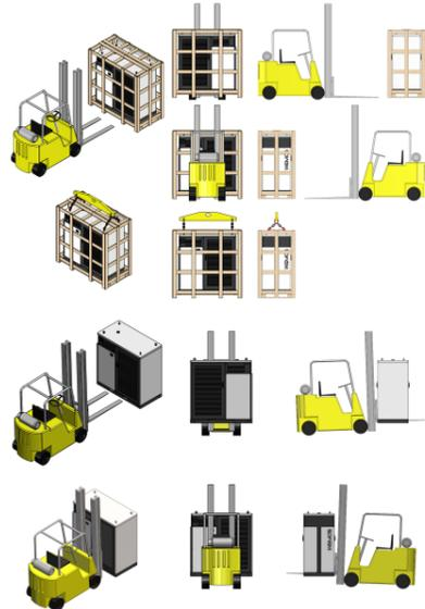
Figura 4.3: Procedimento para movimentação com empilhadeira ou talha
