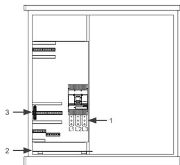
Figura 5.1: Conexões dos cabos de alimentação - Fases (L1-L2-L3) e aterramento (PE)
