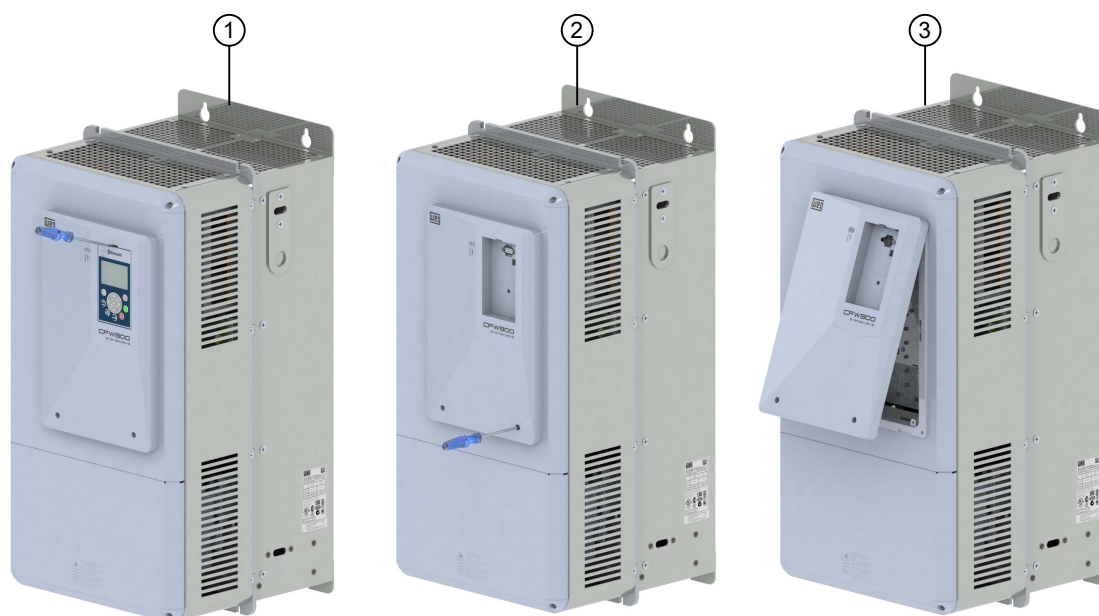
Figura 3.6: Remoción de la HMI y de la tapa del rack de control
