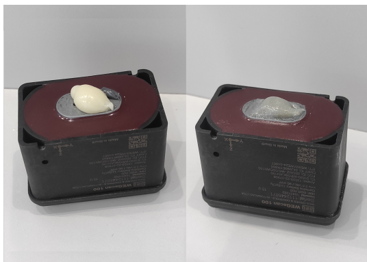
(a) Aplicação de adesivo na base do sensor
