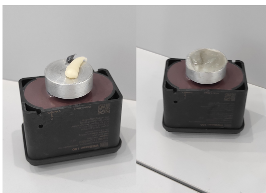
(b) Aplicação do adesivo no suporte
