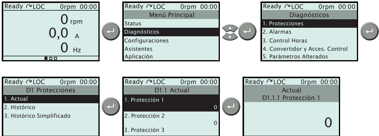
Figura 4.6: Lectura de protecciones activas
