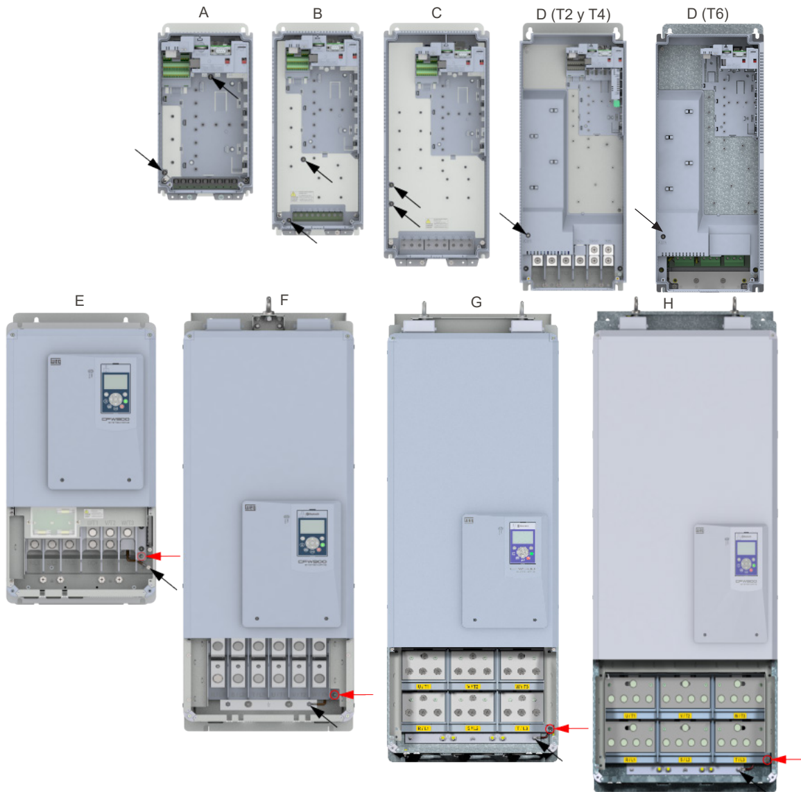
Figura 3.24: Tornillos de puesta a tierra de los condensadores de filtro y varistores
