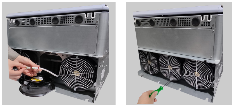
(a) Conexión del cable
