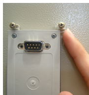
3 - Fijación del HMI al tablero. Ponga los soportes con los tornillos en la parte interna del tablero
