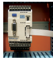
6 - Conecte a outra extremidade do cabo à Unidade de Controle (UC) ou à Unidade de Expansão Digital (EDU)
