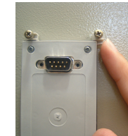
3 - Fixação da HMI ao painel. Coloque os suportes com os parafusos pela parte interna do painel
