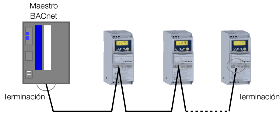
Figura 4.1: Ejemplo de instalación en red BACnet
