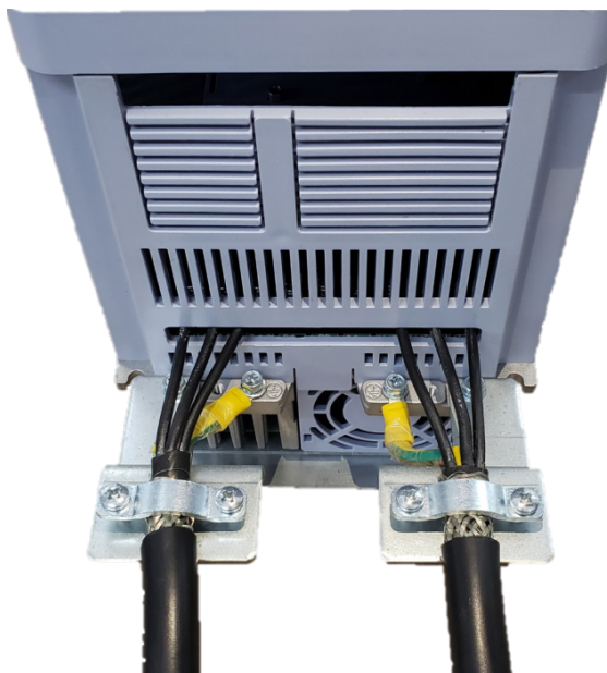
Abbildung 3.28: Beispielhafte Ausführung der Schirmkontaktierung an P
