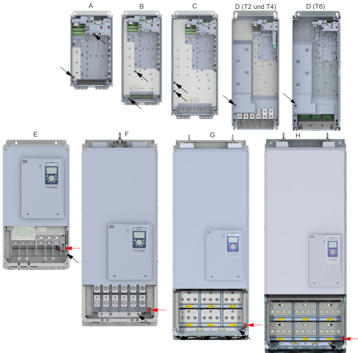
Abbildung 3.24: Erdungsschrauben für Filterkondensatoren und Varistoren
