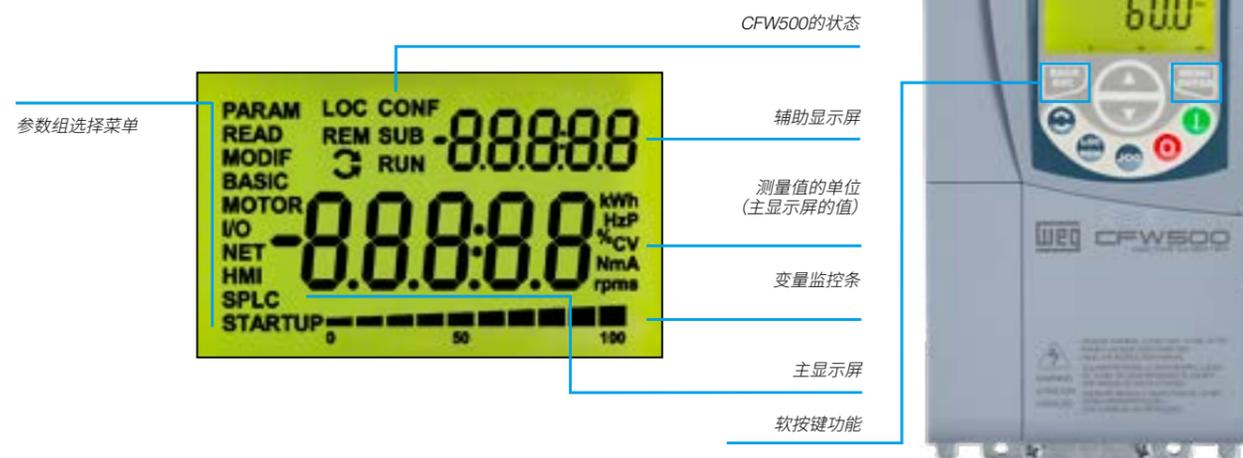
注意: CFW500的操作界面 (HMI) 是不可移动的, 对于远程操控面板, 请根据第 21 页的辅助配置表使用CFW500-HMIR 辅助配置。
