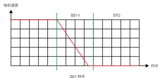
注意：1) 安全功能 STO 和 SS1 在带有 CFW500-SFY2 插件模块的 CFW500 G2 中可用。满足 IEC 61800-5-2, EN ISO 13849-1, EN 62061, IEC61508 和 IEC 60204-1 等标准中规定的安全性能 SIL3/PL e 的要求。
