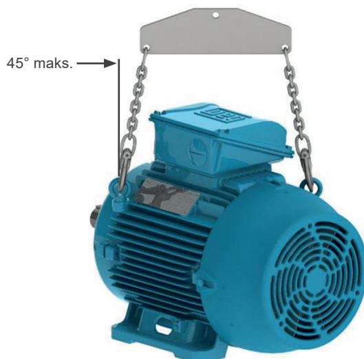
Figur 4.4: Maksimal resultatvinkel for motorer med to eller flere løfteøyer
