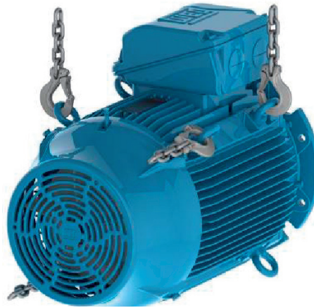
Figur 4.11: Montering av det andre paret øyebolter
