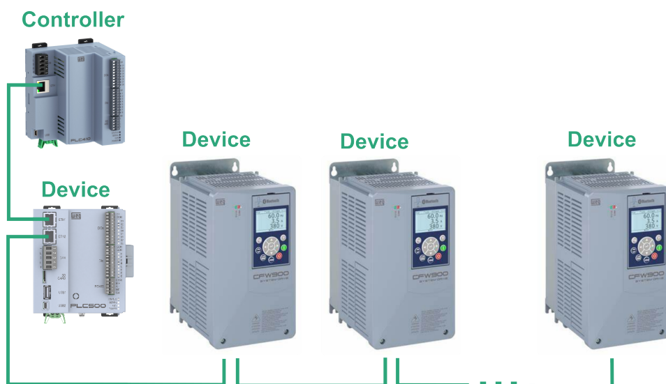
Figura 2.6: Topología en cadena (daisy-chain) PROFINET.
