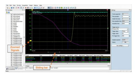
O "Lista de Sinais", na parte inferior da janela, mostra as informações de aquisição (valor mín/máx da forma de onda, cor e unidade de medida).
