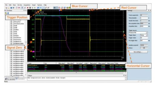
A cor da forma de onda, a escala e exibir valores mín/máx podem ser alterados usando o botão "View settings" na área de configurações.
