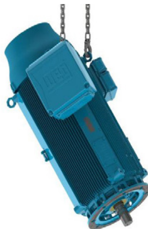
Figura 4.15: Suspensión de motor HGF, W50 y W51 HD por los cáncamos traseros
