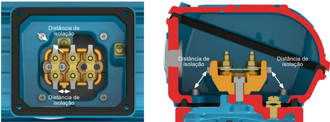
Figura 6.14: Representação da distância de isolamento
