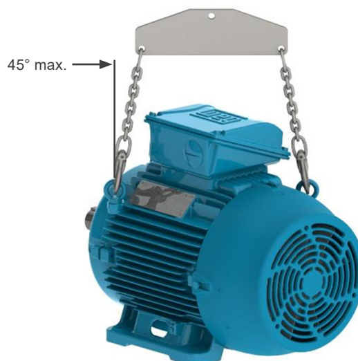
Figura 4.4: Ângulo máximo resultante para motores com dois ou mais olhais de içamento
