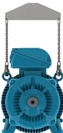
Figura 4.7: Uso de barra separadora en el izamiento
