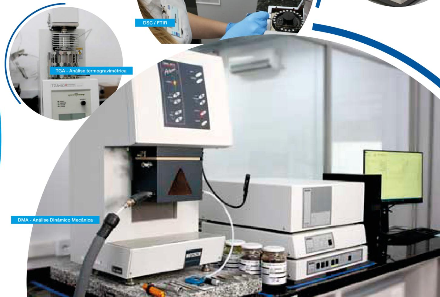
DMA - Analise Dinâmico Mecânica
