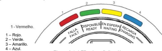
Figura 6.1: LEDS de señalización
