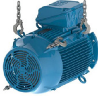
Şekil 4.10 – İkinci delikli cıvata çiftinin monte edilmesi.
