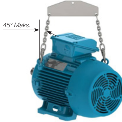
Şekil 4.4 — İki veya daha fazla kaldırma delikli cıvatalı motorlarda ortaya çıkan maksimum açı.
