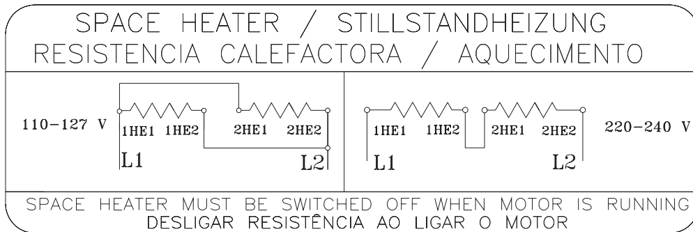
Şekil 6.18 - Çift gerilimli mekan ısıtıcısının bağlanması
