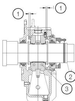
Figura 4.9: Cojinete de deslizamiento
