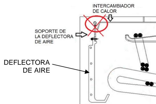
Figura 8.3: Montaje incorrecto del intercambiador de calor
