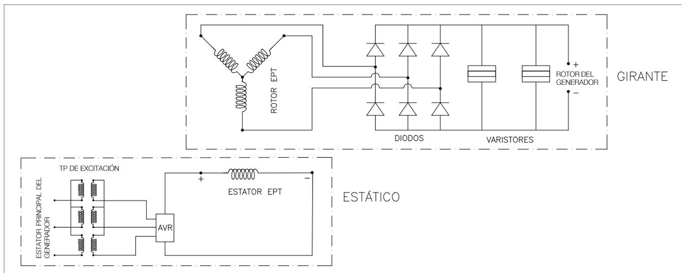
Figura 5.2: Circuitos eléctricos internos del generador sin PMG
