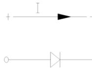
La conducción de corriente debe ocurrir solamente en sentido ánodo-cátodo, o sea, en la condición de polarización directa.
