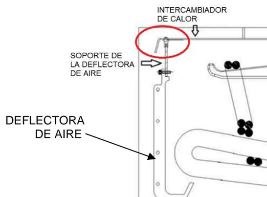
Figura 8.2: Montaje correcto del intercambiador de calor
