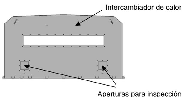
Figura 8.1: Intercambiador de calor
