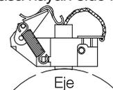
Figura 7.1: Escobilla para puesta a tierra del eje
