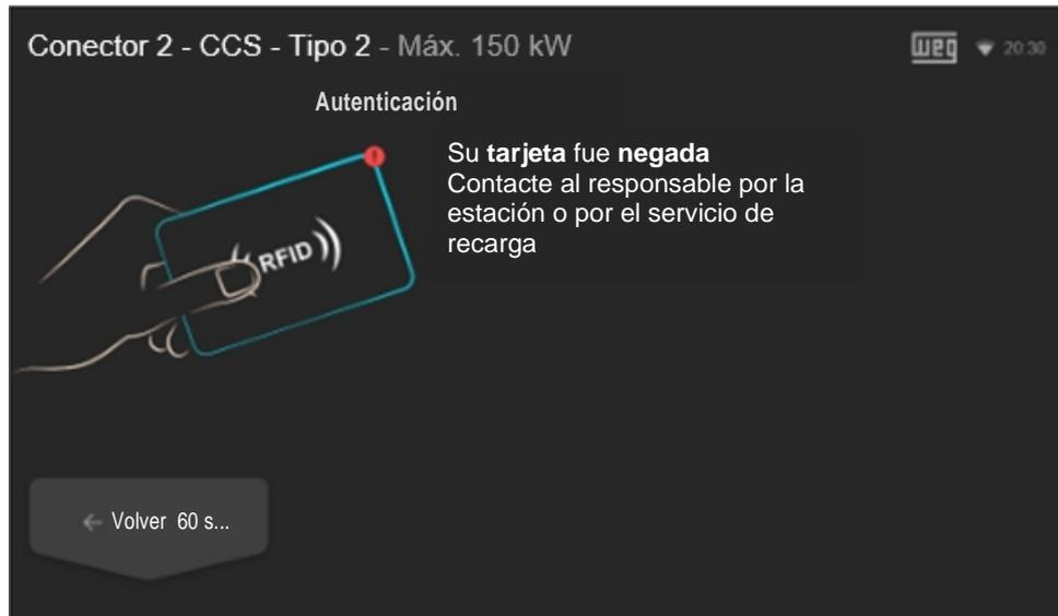
Figura 36: Pantalla indicando problema en la autenticación de la tarjeta RFID
