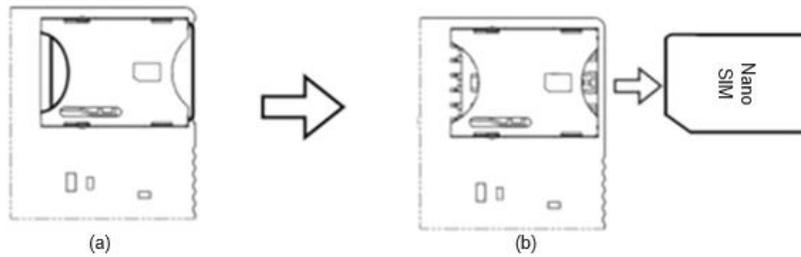
Figura 23: Procedimiento para retirar la SIM Card
