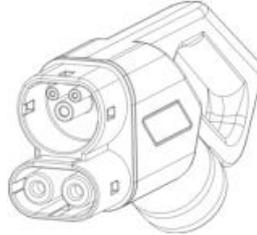
Figura 3: Modelo del conector de la WEMOB-STATION CCS-2
