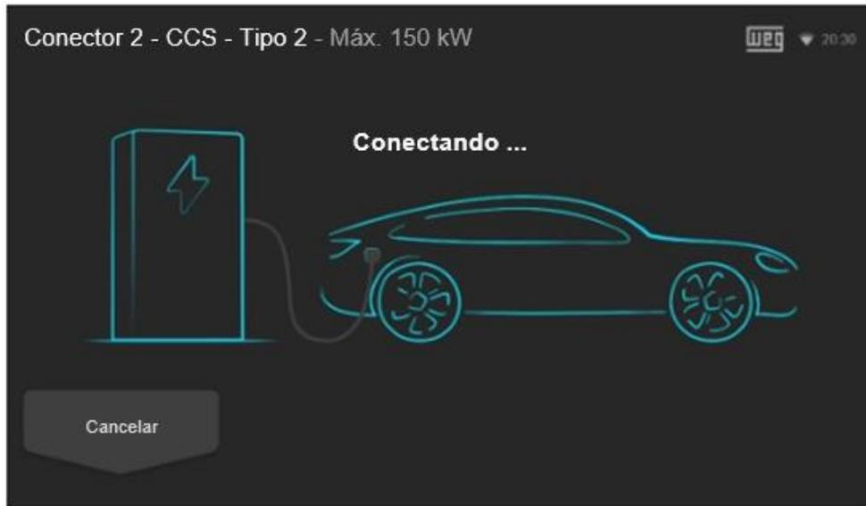
Figura 29: Pantalla indicando que el vehículo eléctrico fue conectado y está en proceso de reconocimiento
