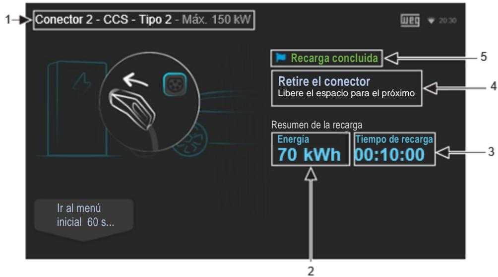
Figura 43: Pantalla con detalles de una recarga concluida
