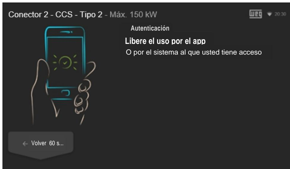
Figura 33: Pantalla de liberación de la recarga vía aplicación
