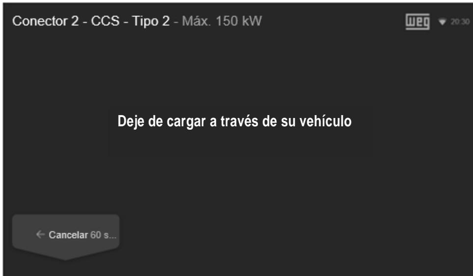
Figura 31: Pantalla informando para finalizar la recarga por el vehículo eléctrico en el Modo de operación "Always Authorized"
