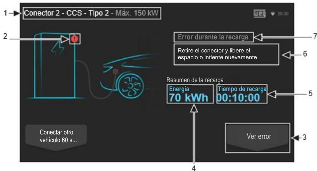
Figura 44: Pantalla con detalles de una recarga interrumpida debido a un error
