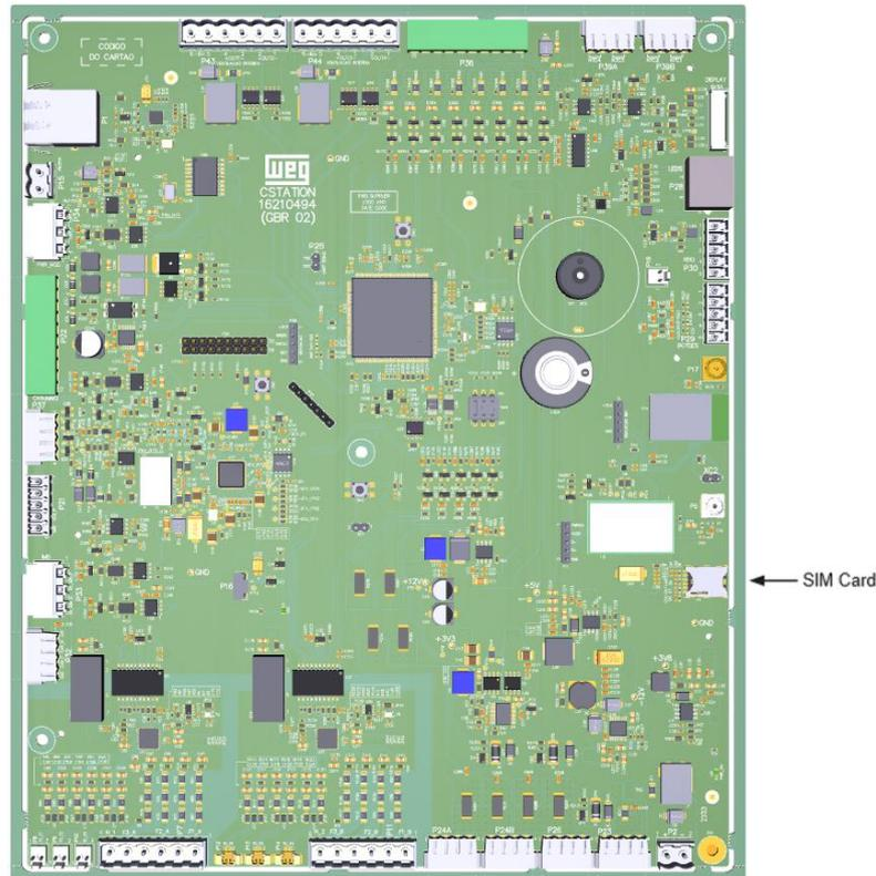
Figura 21: Localización del slot del SIM Card en la tarjeta electrónica de control
