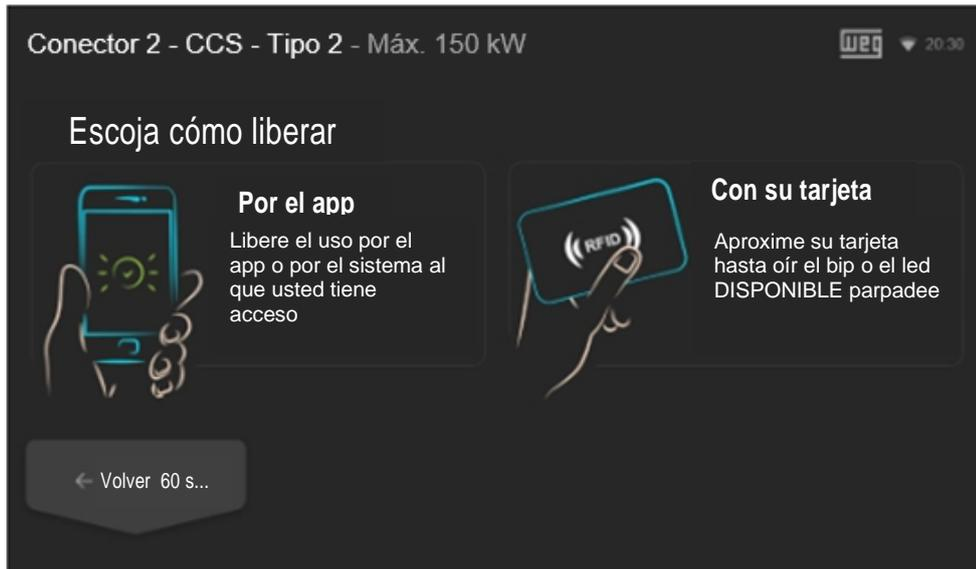
Figura 32: Pantalla para selección del método de liberación (ejemplo 150 kW)
