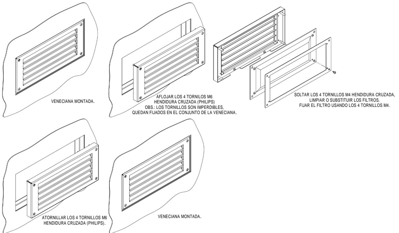
Figura 7: Sustitución de los filtros de aire
