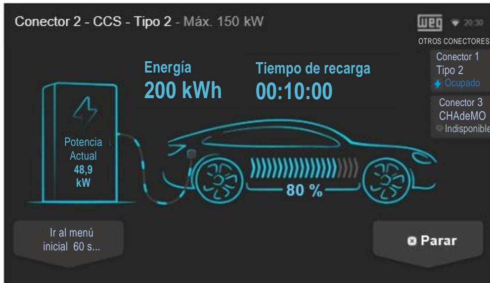
Figura 30: Pantalla con detalles de la recarga en andamiento y botón "Parar"
