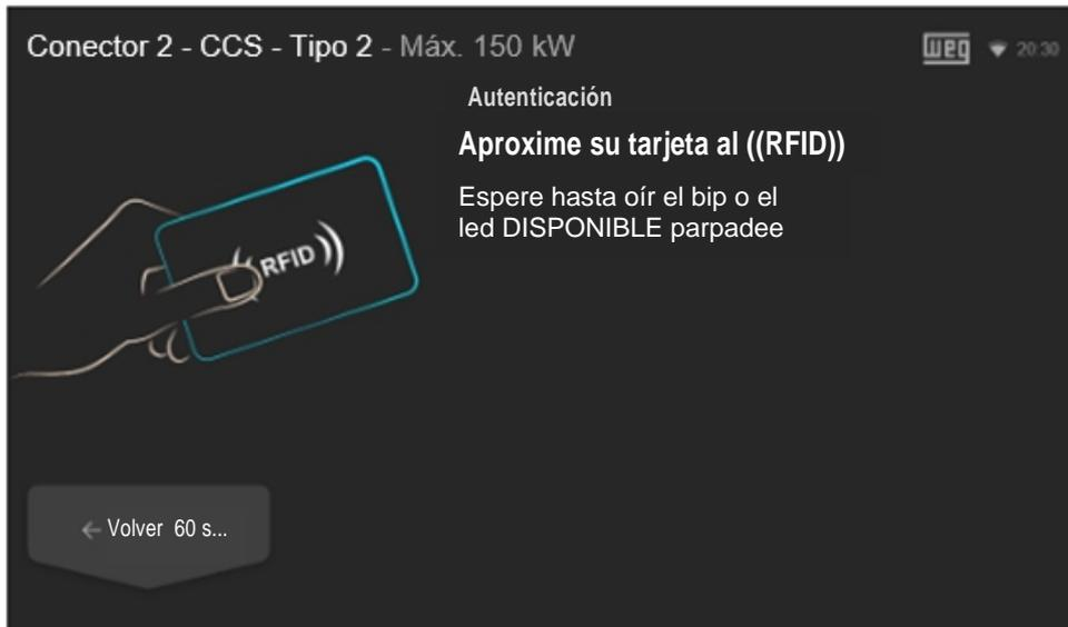
Figura 34: Pantalla con instrucciones para liberación de la recarga vía RFID
