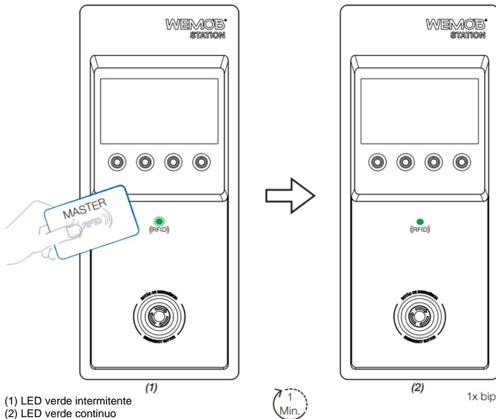
Figura 24: Registro de la tarjeta RFID "Master"
