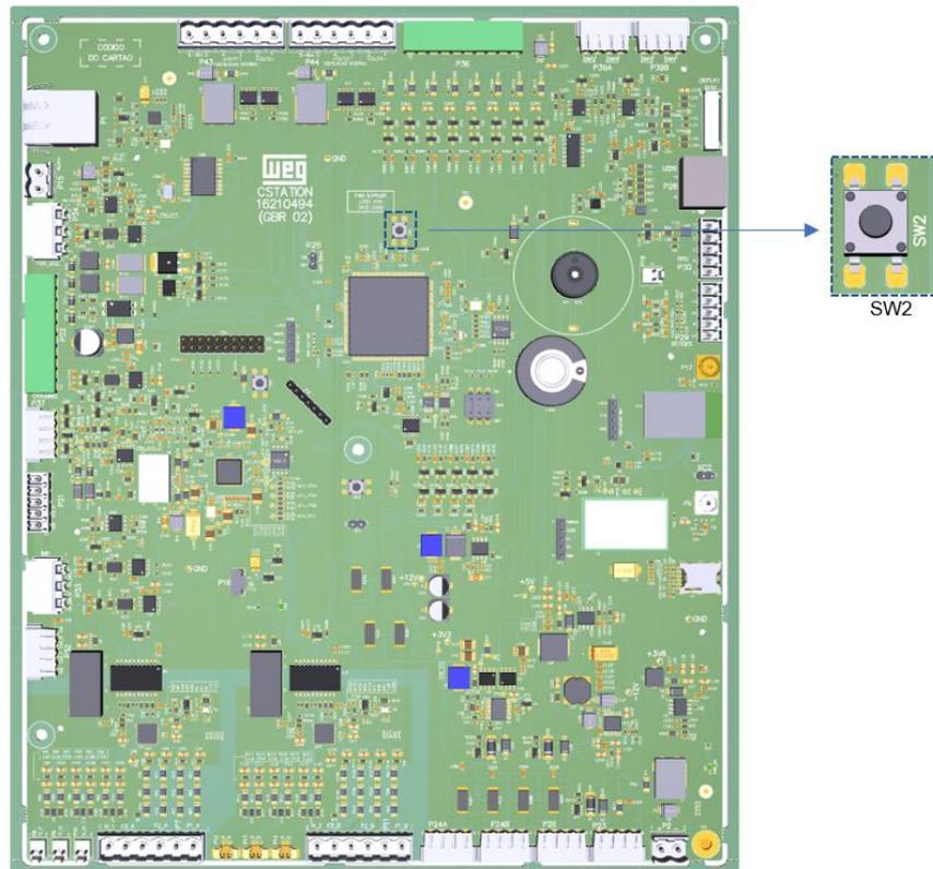
Figura 26: Localización del botón de reset "SW2 – RESET" en la tarjeta electrónica
