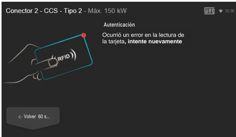
Figura 35: Pantalla indicando un error en la autenticación de la tarjeta RFID
