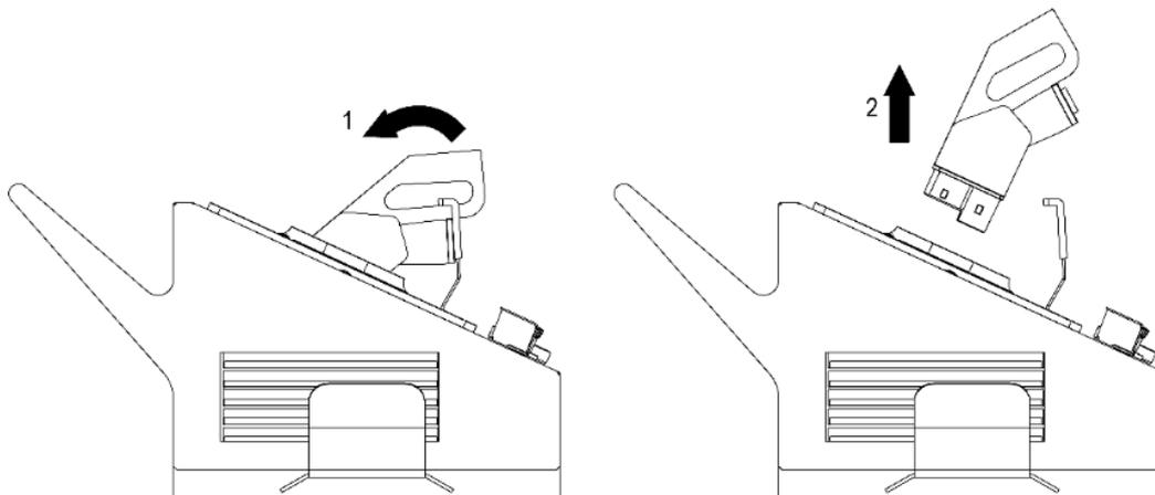
Figura 4: Procedimiento para retirada del conector (plug) de la cuna
