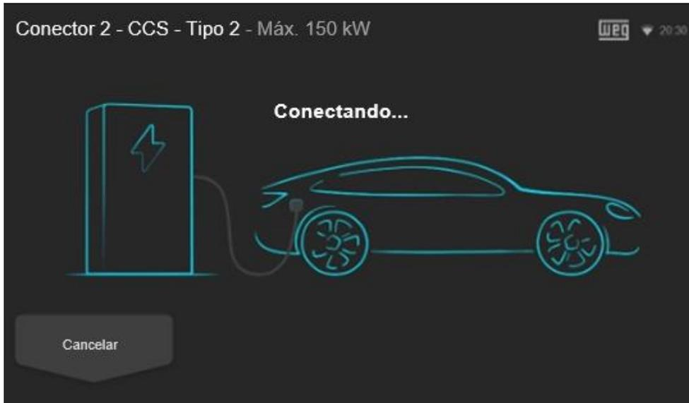
Figura 38: Pantalla indicando que el vehículo eléctrico fue conectado y está en proceso de reconocimiento
