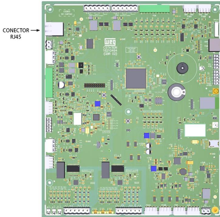
Figura 20: Localización del conector RJ45 en la tarjeta electrónica de control
