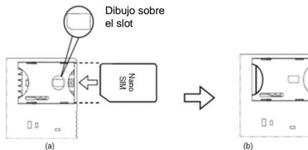
Figura 22: Procedimiento para insertar la SIM Card
