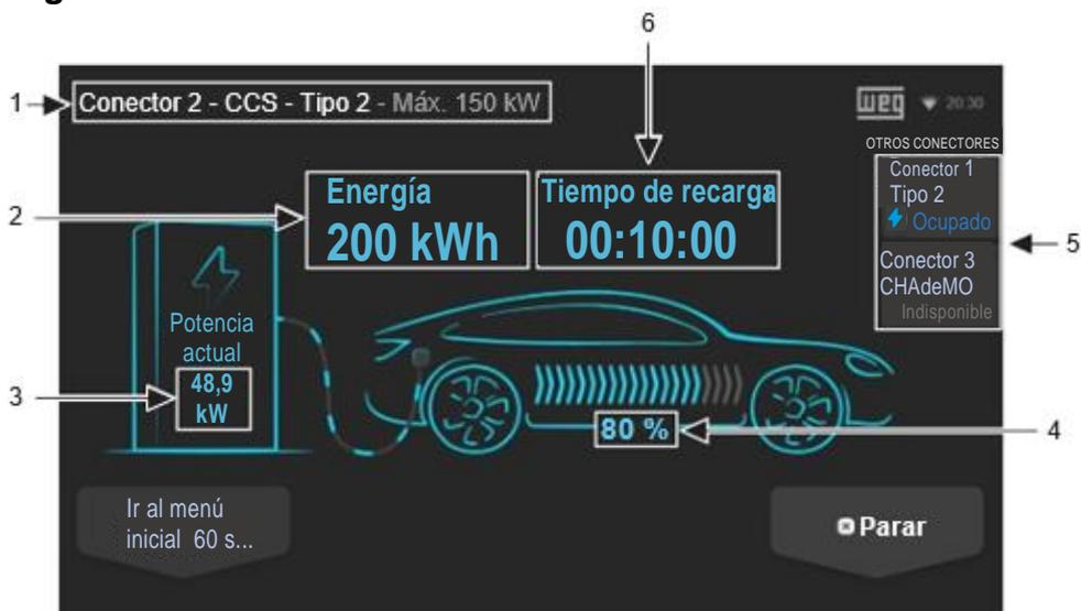
Figura 42: Pantalla con detalles de la recarga en andamiento (ejemplo 150 kW)
