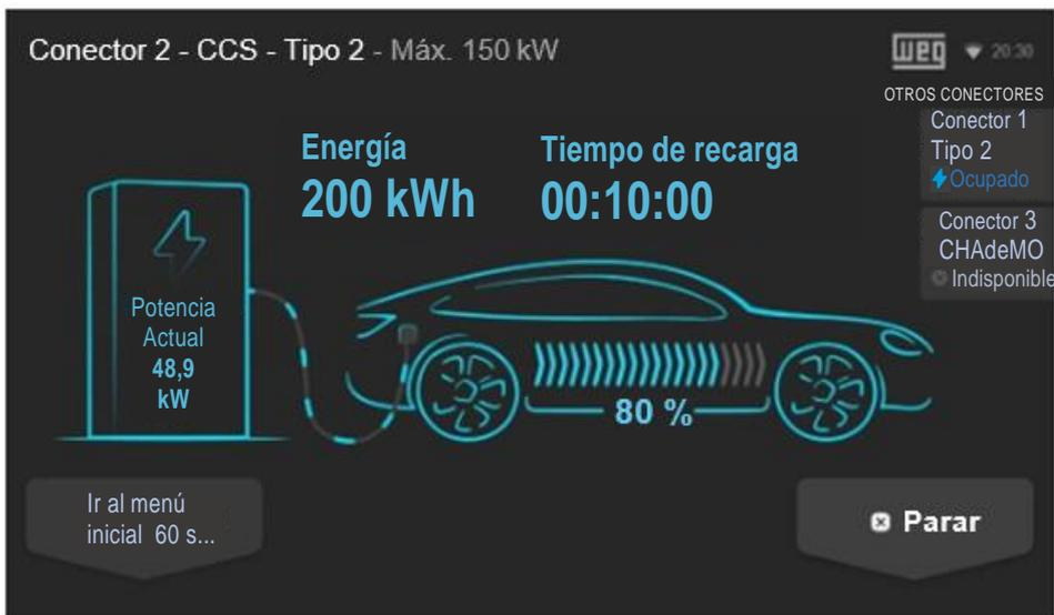
Figura 39: Pantalla con detalles de la recarga en andamiento y botón "Parar"
