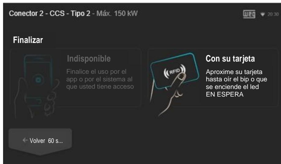
Figura 41: Pantalla de finalización de la recarga vía tarjeta RFID
