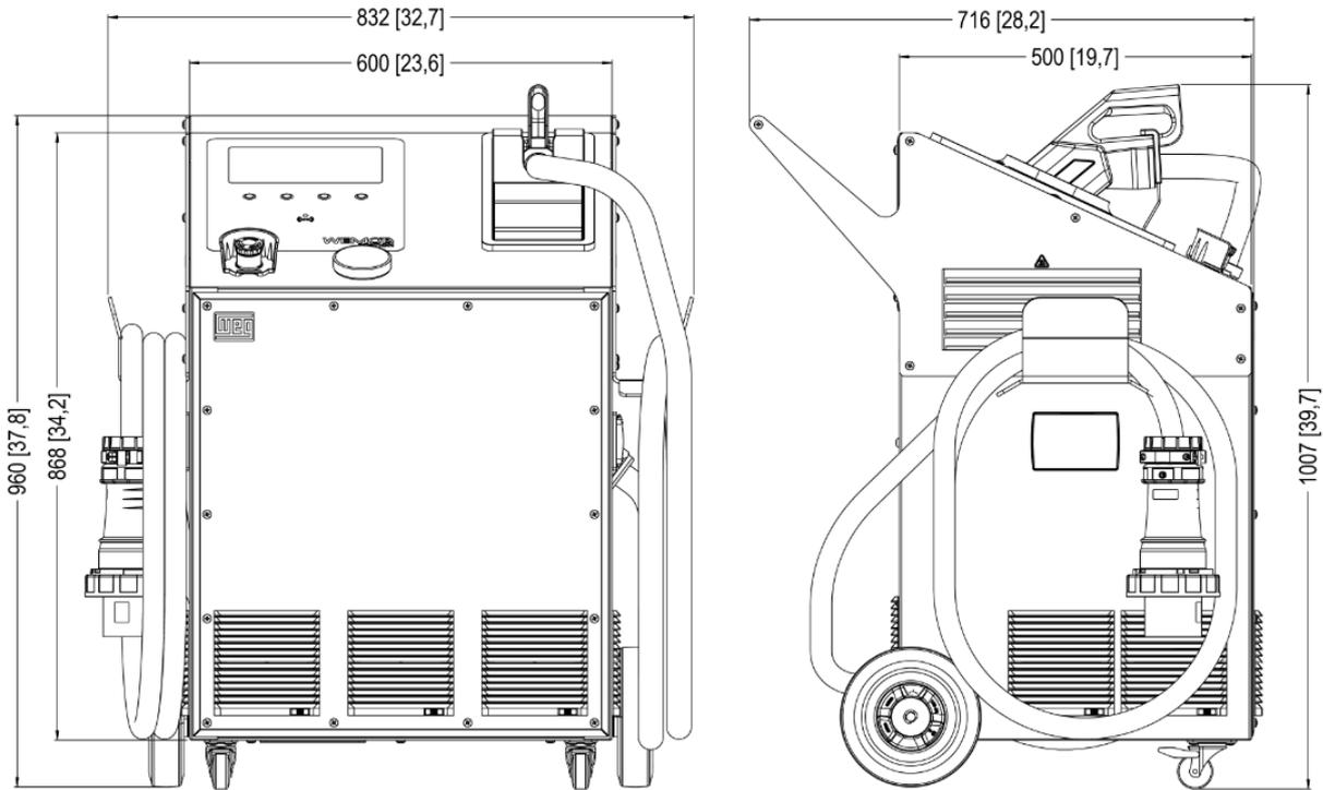
Figura 47: Dimensiones de la WEMOB-STATION en mm y pulgadas – mm [ “ ]
