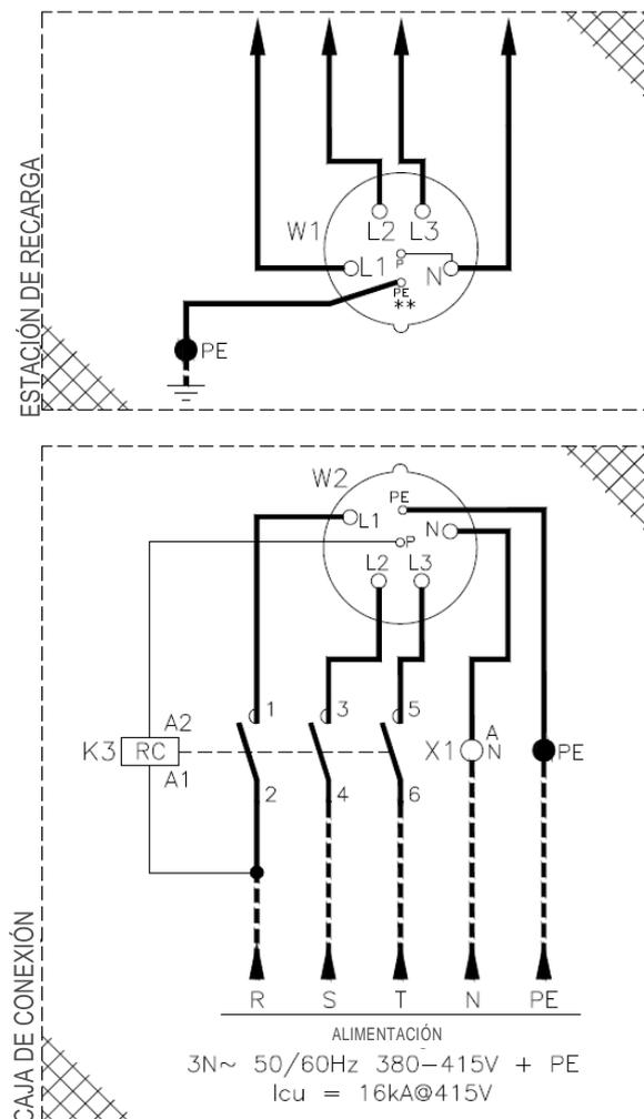
Figura 12: Diagrama de la caja de alimentación
