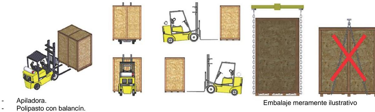
Figura 6: Procedimiento para movimiento con apiladora o polipasto
