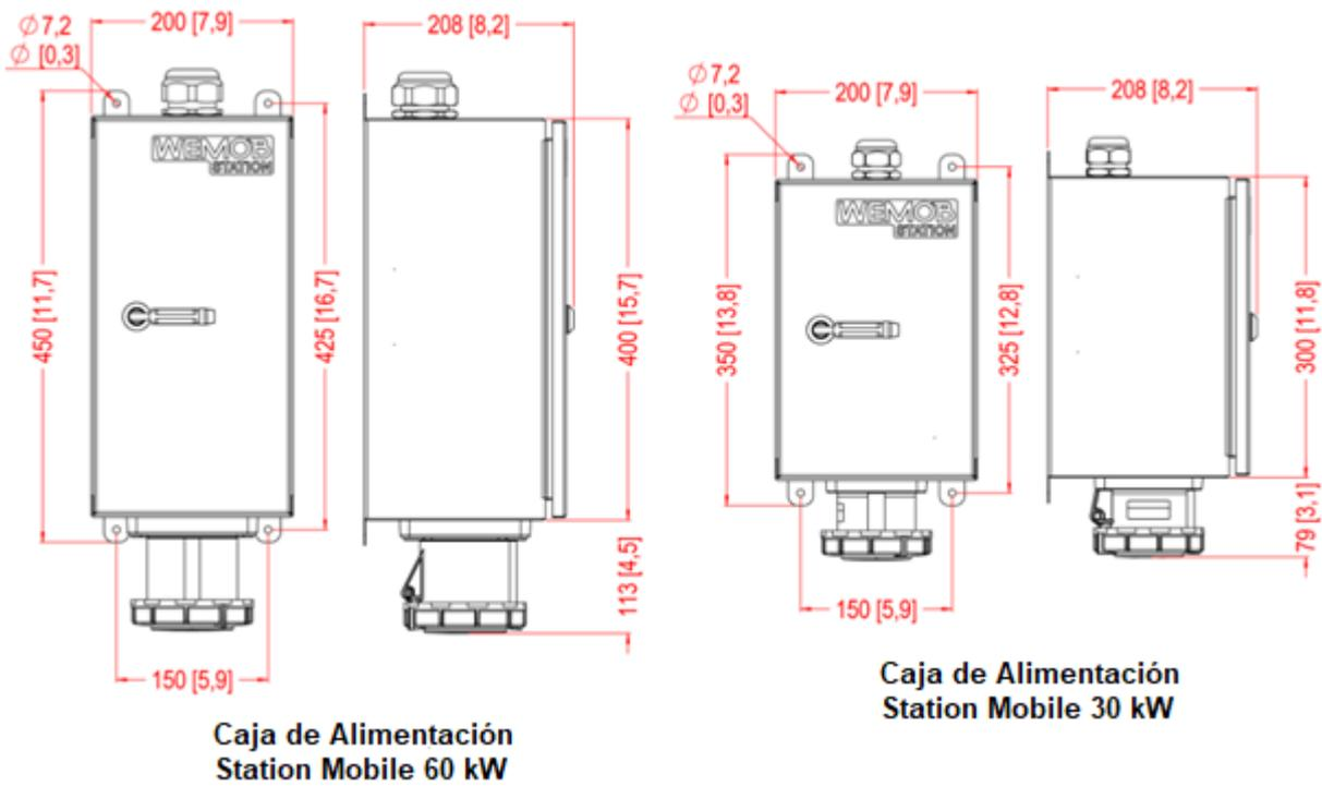
Figura 48: Dimensiones de la caja de alimentación en mm y pulgadas – mm [ “ ]
