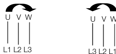
Figura 6.1: Sequência de fases (IEC60034-8)
