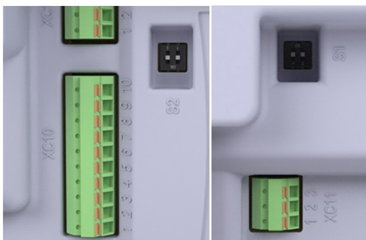
Figura 5.5: a sinistra: morsettiere XC10 (ingressi e uscite principali del prodotto) e tasti S2 (resistori RS 485), a destra: morsettiere XC11 (uscita digitale 1, contatti relè) e tasti S1 (comunicazione seriale forzata)
