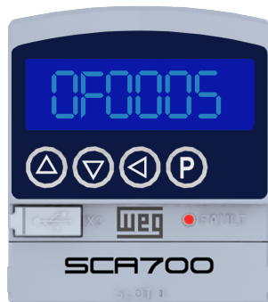
Figura 7.2: Exemplo de indicação de falha no display da HMI
