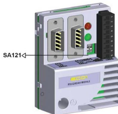
**Figura 2.1:** Resistor de terminação
