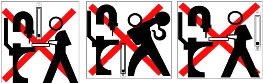
Figura 3.5: Posicionamiento incorrecto del LGW300
