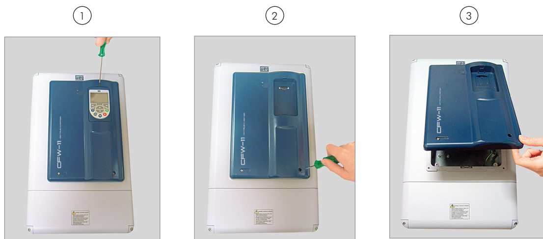
Afbeelding 3.6: Verwijdering van HMI en afdekplaat van bedieningsconsole
