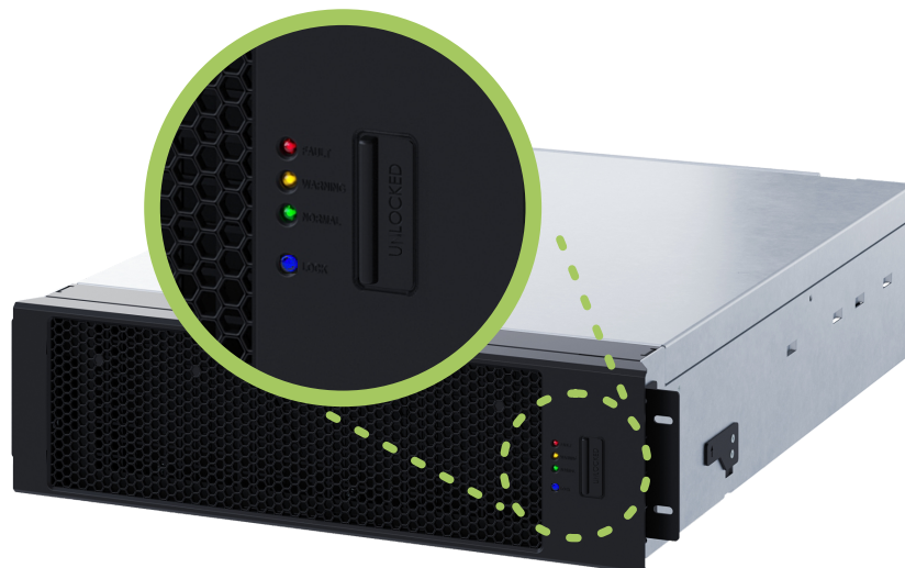
Figura 8.4: Módulo de bypass com a trava hotswap na posição destravado (unlocked)
