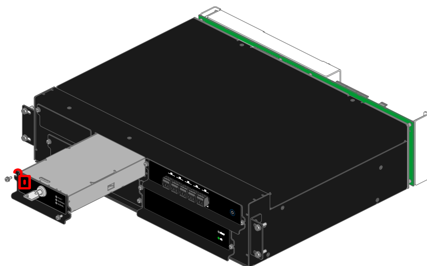
Figura 8.6: Módulo de controle com a trava hotswap na posição destravado (unlocked)
