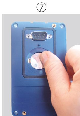
Presionar la batería para el encaje
