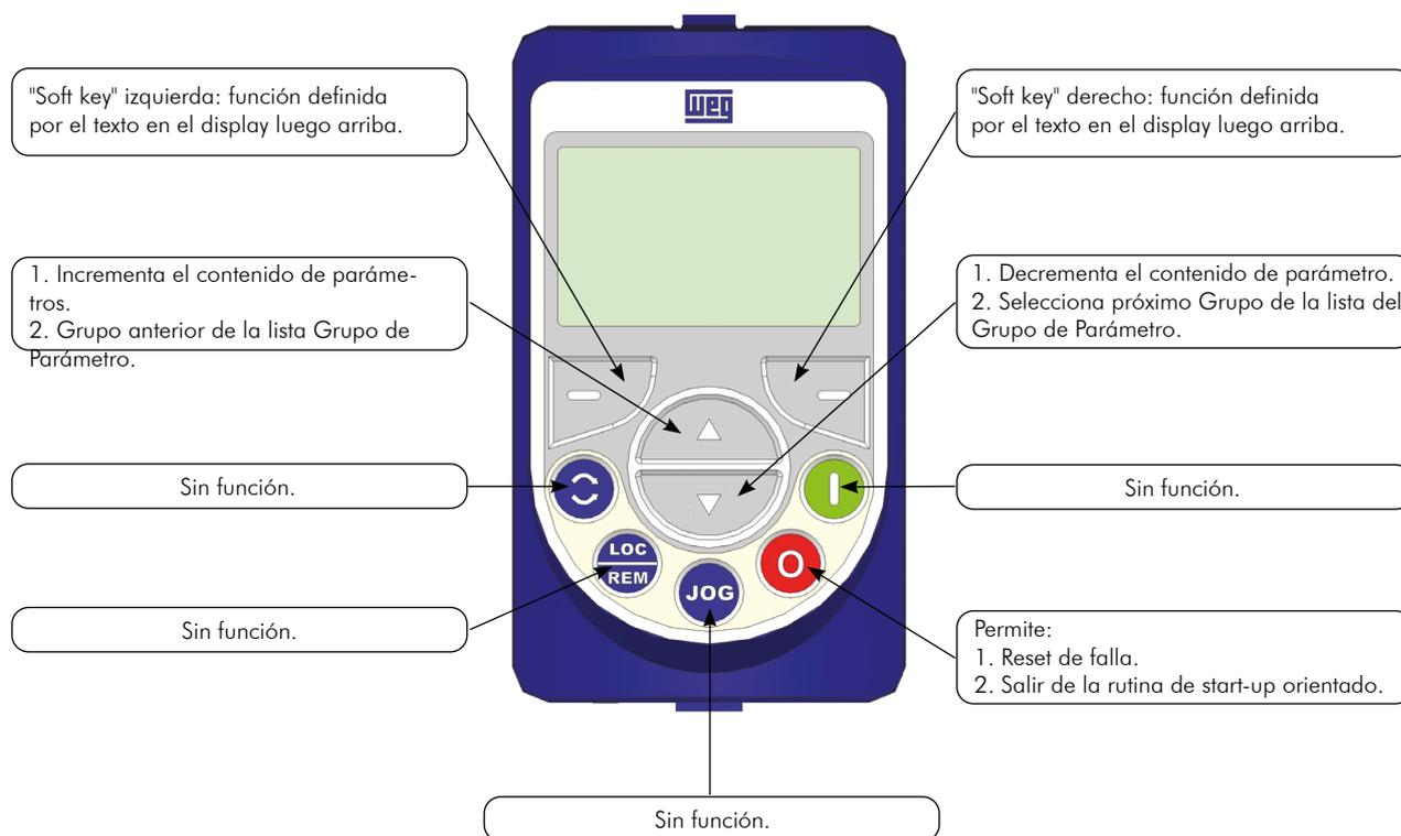
**Figura 4.1:** Teclas de la HMI
