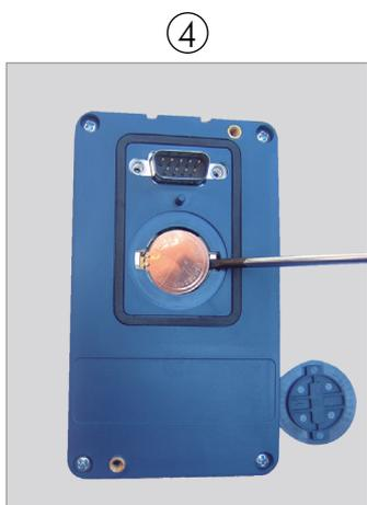
Quite la batería con el auxilio de un destornillador plano posesionándole en el canto derecho
