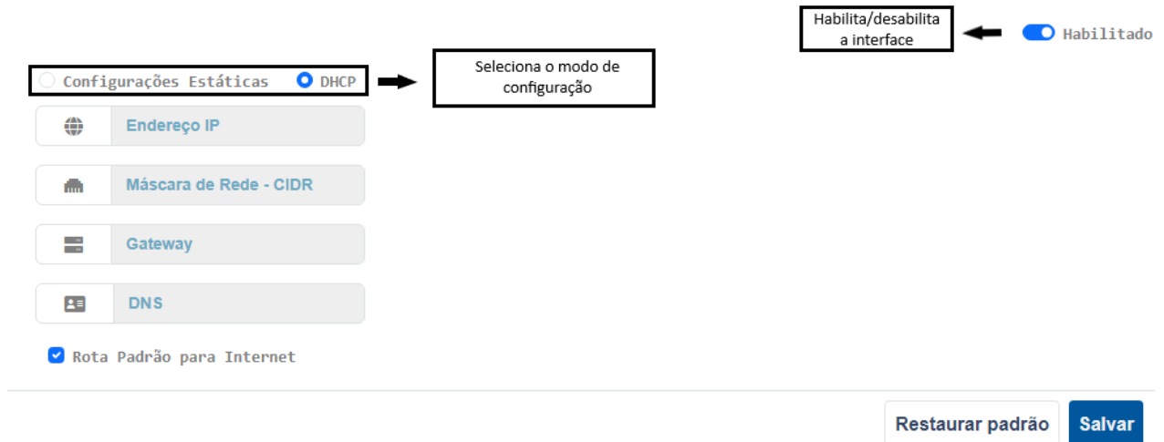
Figura 4.5: Tela de configuração da interface Ethernet
