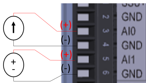
Figura 2.7: Exemplo de conexão das entradas analógicas.
