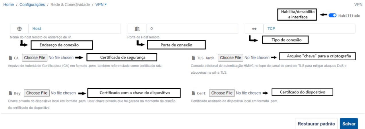
Figura 4.7: Tela de configuração da interface VPN
