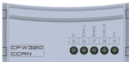
Figura 2.2: Detalle do conector CAN
