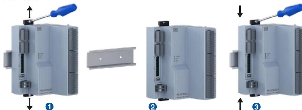
Además de la posibilidad de fijación en riel DIN, la RUW100 puede ser instalada en estructuras planas, como paredes y fondos de tableros, a través de tornillos M3, para eso:
