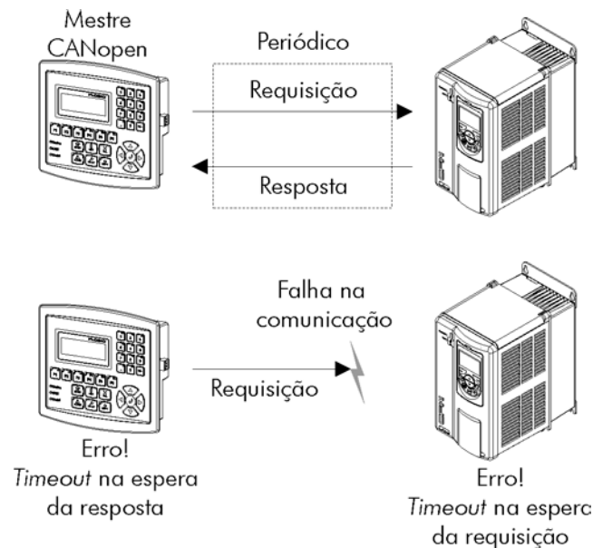
Figura 7.5: Serviço de controle de erros – Node Guarding
