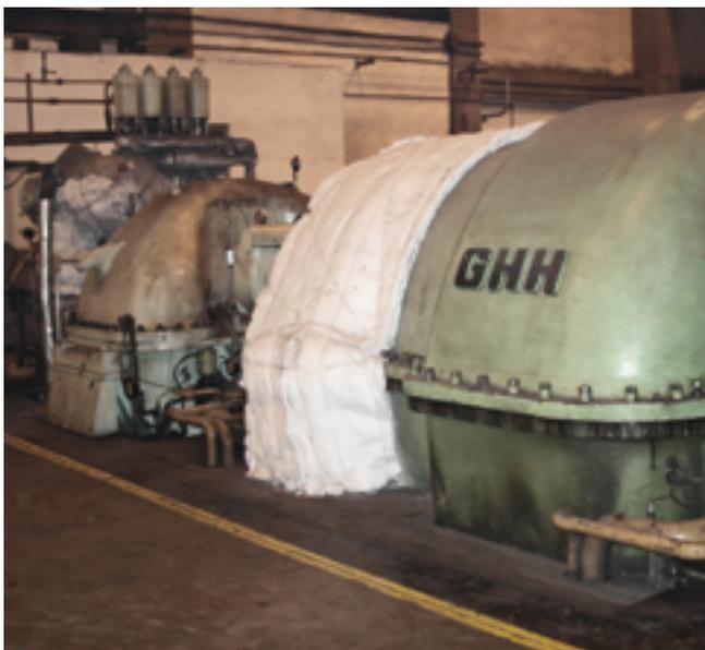
Recuperação da face de junção: Vazamentos de vapor, gás e líquidos na face de junção podem provocar acidentes ou perdas de rendimento, além de prejudicar o meio ambiente. Se a retirada do equipamento estiver impossível para envio à fábrica, utilizamos uma técnica de recuperação da face de junção em campo com aplicações de materiais. Eliminamos os vazamentos, deixando o equipamento em condições normais e sem riscos durante a operação.
