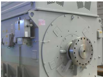
Figura 9: Máquina con cojinete único
