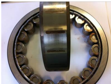
Figura 24: Impresiones superficiales (false brinelling)
