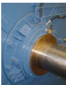
Figura 6: Cojinete de rodamiento a grasa
