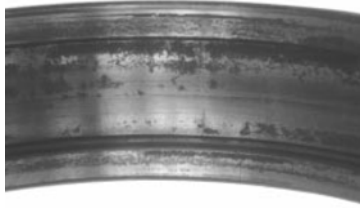
Figura 23: Corrosión estática en la pista externa del rodamiento
