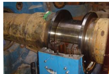
Figura 27: Corrosión en el eje
