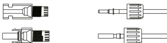
Figura 5.13: Conectores CC com os Cabos Crimpados.
