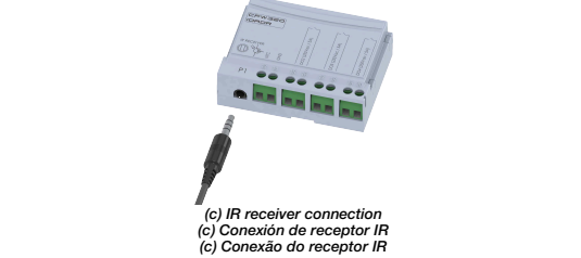
(a) Remoção da tampa de proteção da conexão dos acessórios de expansão de IO's (b) Conexão do acessório (c) Conexão do receptor IR
