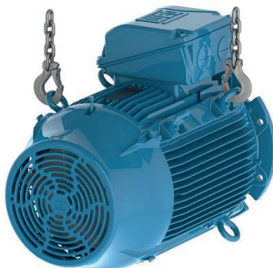
Фигура 4.22: Краен резултат: двигателят е поставен в хоризонтално положение
