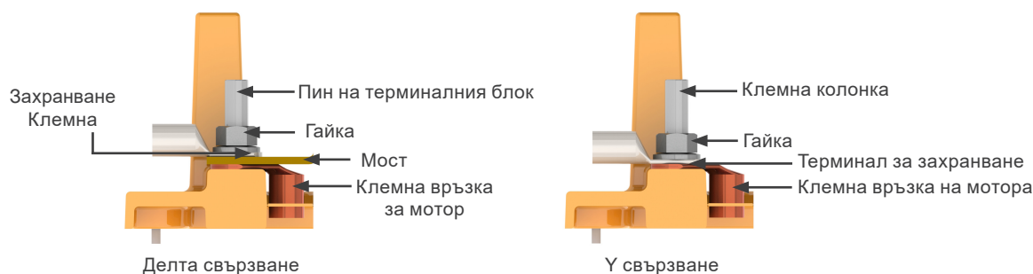
Фигура 6.15: Свързване за клемни блокове KWLV* и KWMV
