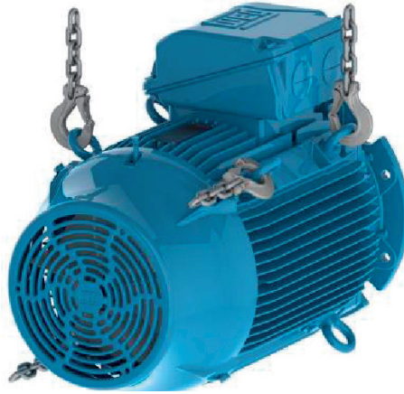
Фигура 4.11: Монтиране на втората двойка винтове с ухо
