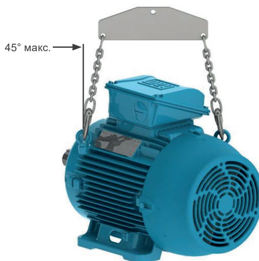
Фигура 4.4: Максимален резултатен ъгъл за двигатели с две или повече повдигащи скоби
