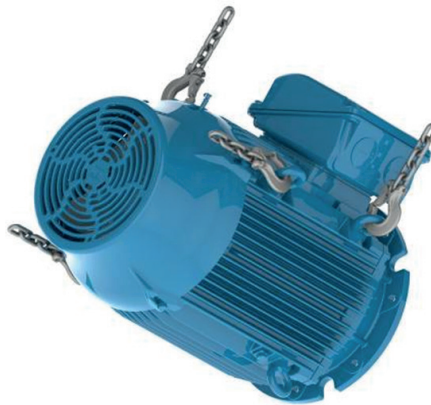
Фигура 4.21: Двигателят се върти до хоризонтално положение
