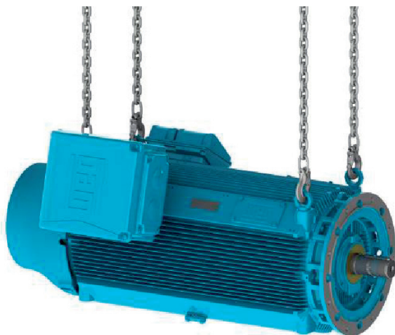
Фигура 4.15: Повдигане на двигатели HGF, W50 и W51 HD с два подемника
