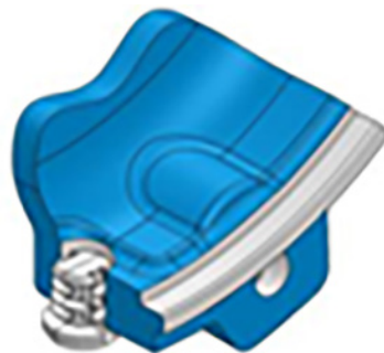
Фигура 6.2: Детайл на автоматичния изпускателен клапан, който не изисква ръчна намеса
