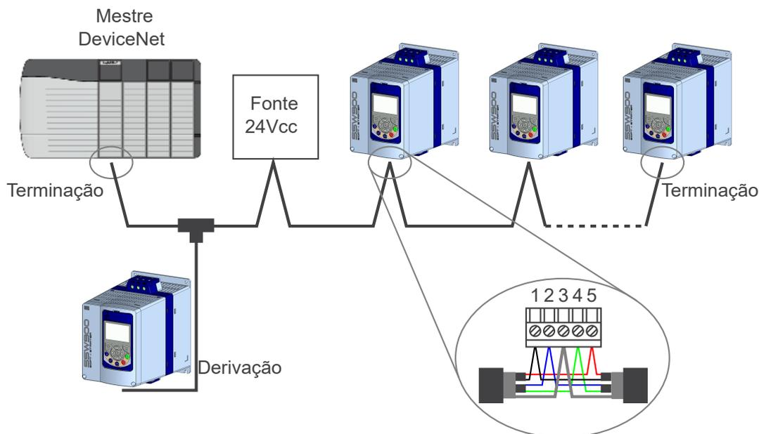
Figura 3.1: Exemplo de instalação em rede DeviceNet
