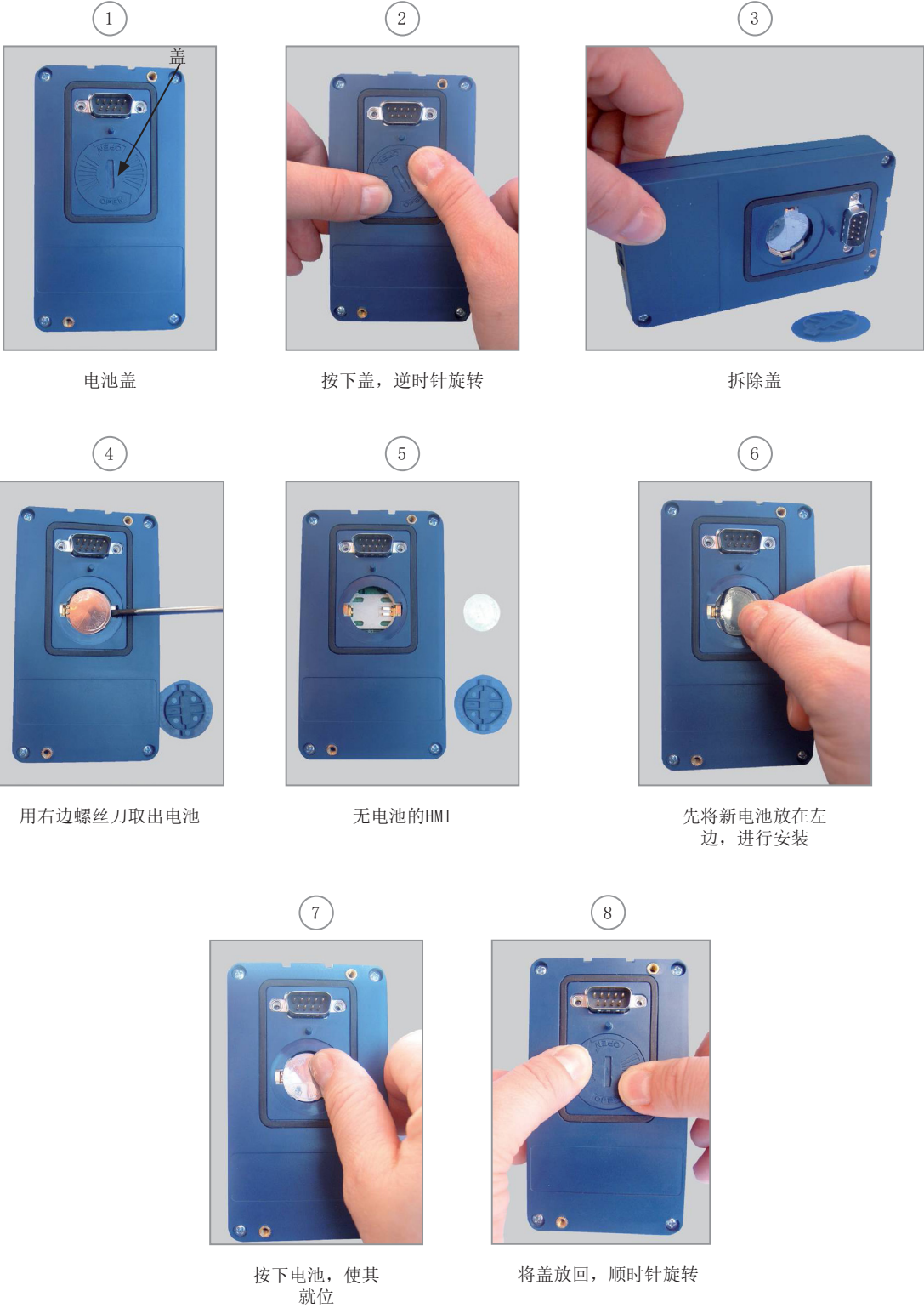
图4. 4: 更换HMI电池
