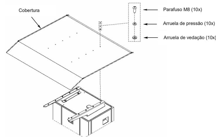
Figura 3.3: Detalhe da montagem da cobertura.
