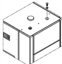
Figura 3.1: Detalhe da remoção dos parafusos.
