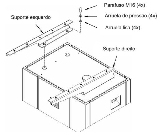
Figura 3.2: Detalhe da montagem dos suportes.
