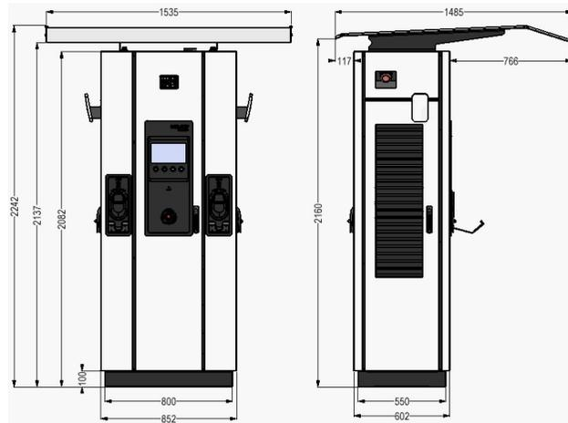
Figura 2: Visão geral da estação de recarga WEMOB STATION com a cobertura - mm.
