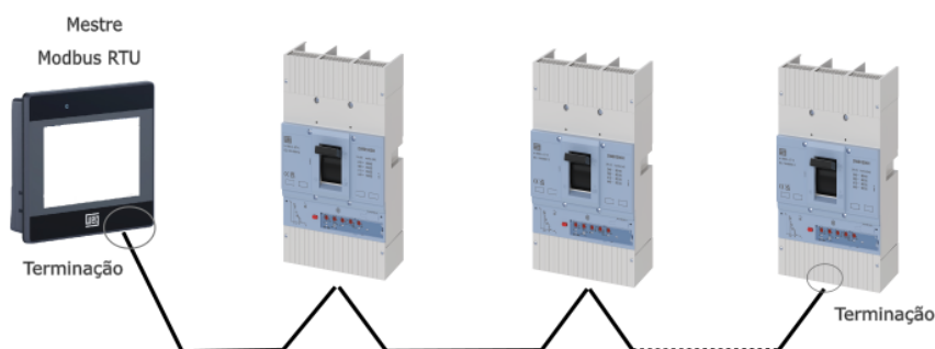
Figura 4.1: Exemplo de instalação em rede Modbus RTU
