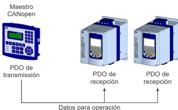
Figura 8.2: Comunicación utilizando PDOS
